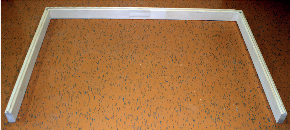
Abb. 1: Auflegen der drei Bodenrahmen-Elemente
