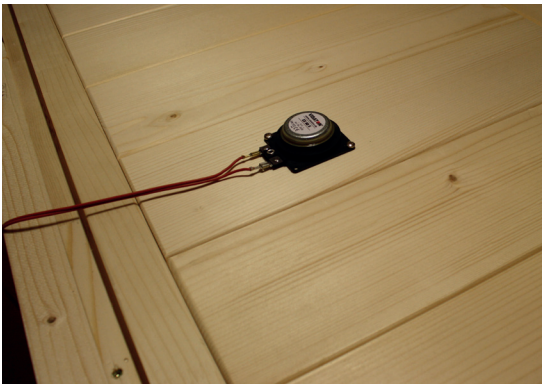
Abb. 47: Montage der Exciter
